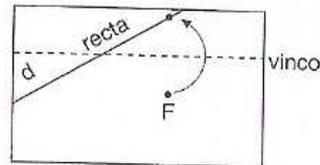
Dobra-se o papel, de modo que F coincida com um ponto qualquer da recta e vinca-se bem a dobra. Repete-se a operação usando diferentes pontos da recta. Os vincos ficam todos tangentes a uma parábola que começa a delinear-se no papel.
