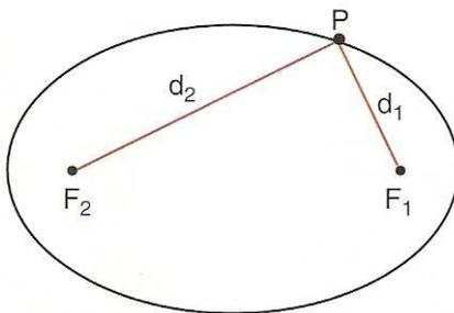
Por definição,  $d_1 + d_2 = \text{constante}$ ,  $F_1$  e  $F_2$  são os focos.  $F_1F_2$  é a distância focal.  $[PF_1]$  e  $[PF_2]$  são raios focais.
