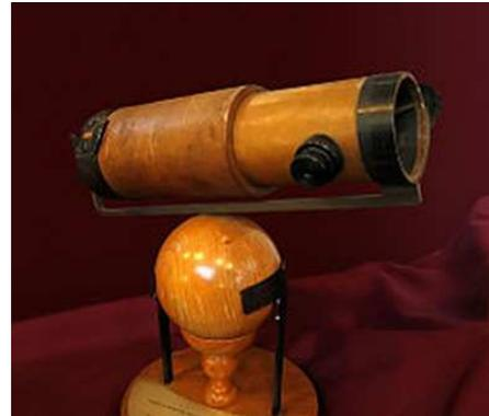
adequado, pois tinha de ser de alta qualidade e sem falhas para minimizar quaisquer distorções; a flexão dos raios luminosos separa as cores contidas na luz branca introduzindo uma distorção, chamada aberração cromática. O primeiro problema foi eliminado e o segundo reduzido usando um espelho em vez de uma lente.
