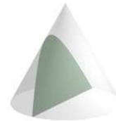
3. **Hipérbole**- é a cónica definida pela intersecção de um plano com uma superfície cónica, sendo o plano paralelo ao seu eixo.
